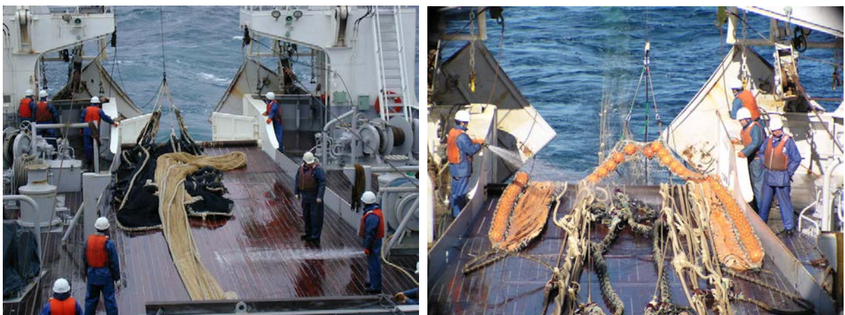
図5 開洋丸船尾からの表層トロールの投網。左、網の先端部（黒い部分）。右、網の開口部。
