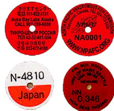
図10 サケ・マス類の標識放流に用いられてきたNPAFCのディスクタグ。沖合における標識放流活動の初期に、いくつかの標識が比較され、ディスクタグが主に使用されるようになった。
